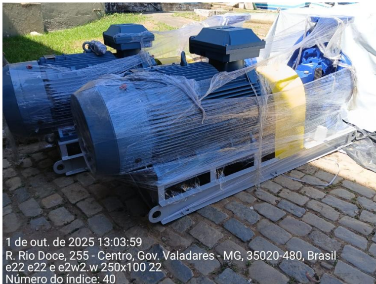
Figura 23 - Fornecimento de conjunto de motobomba
